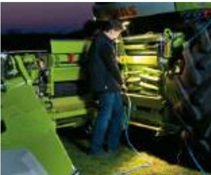
O QUICK ACCESS permite inspecionar os elementos do picador em apenas alguns minutos.
