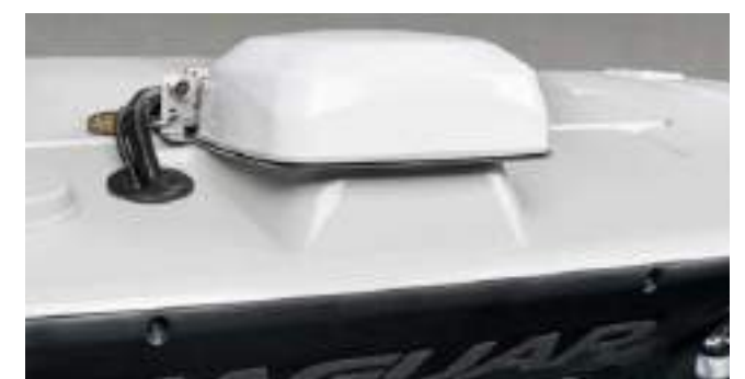
Antena SAT 900 e receptor unidos, com dispositivo antifurto
