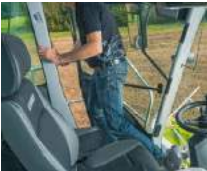
O interruptor do assento desliga automaticamente a plataforma e o acionamento principal.
